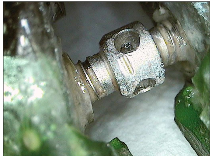
Abb. 4: Deutlich sichtbare Korrosion an KFO Apparatur (Foto: S. Dietsche).
